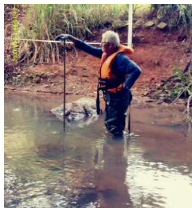
Foto 2 – Medida das seções verticais para o monitoramento Psed – 21ª campanha. (Data: 21/05/2021).
