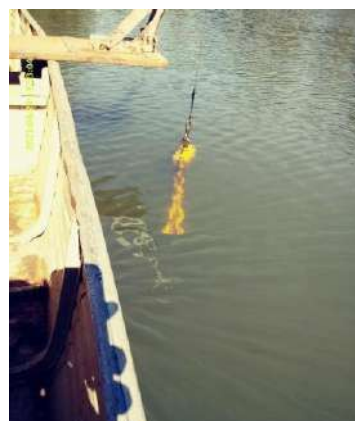
Foto 4 – Amostragem de sedimento em suspensão no PHM – 22ª campanha. (Data: 24/06/2021).
