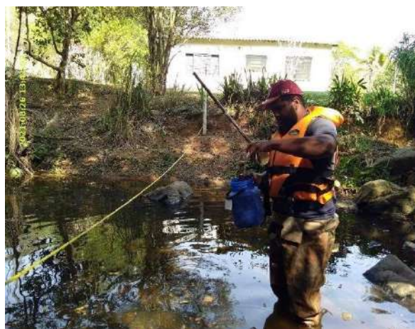
Foto 7 – Amostragem de sedimento em suspensão no PSed – 24ª campanha. (Data: 26/08/2021).
