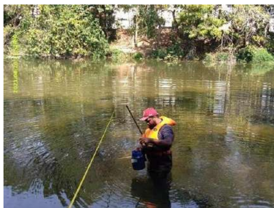
Foto 8 – Descarga líquida no PHJ. (Data: 26/08/2021).
