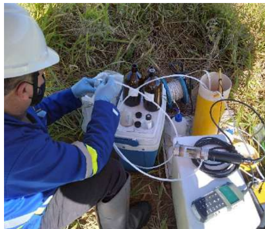
Foto 5. Foto com ênfase no processo de coleta da água subterrânea em frascarias adequadas para envio à análise. PM-02
