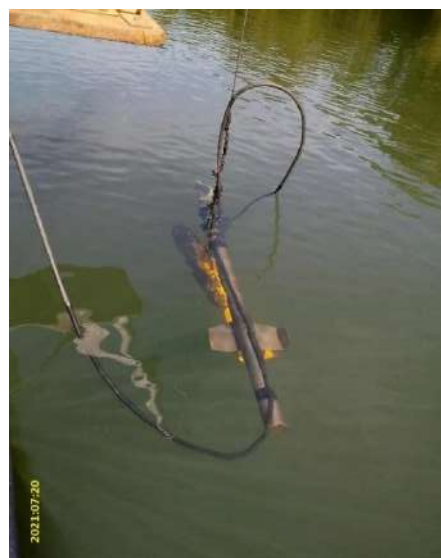
Foto 6 – Amostragem de sedimento em suspensão no PHM – 23ª campanha. (Data: 20/07/2021).
